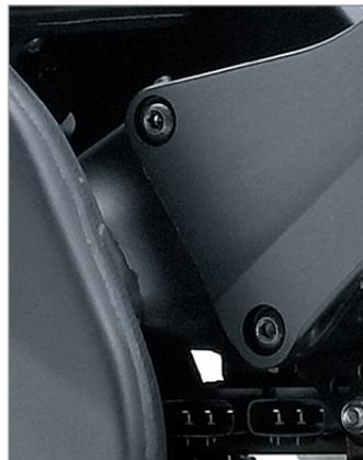
\* Rippen auf der Innenseite der Lagerplatte, wo diese mit der oberen Querstrebe des Rahmens verbunden ist, verzögern das Feedback vom Rahmen an den Fahrer geringfügig, wodurch der Fahrer ein genaueres Gefühl für das Verhalten des Rahmens bekommt.
