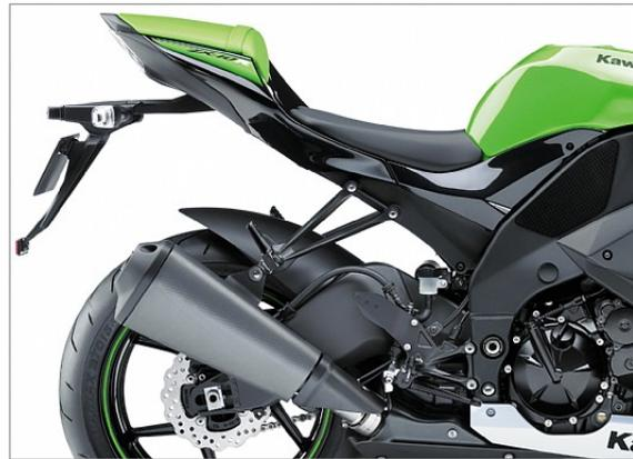
\* Ein großer Innenkotflügel schützt besser vor Spritzwasser und Schmutz im normalen Straßenbetrieb. Der Heckkotflügel konnte daher etwas kleiner und weniger auffällig ausfallen, was wiederum der Aerodynamik am Fahrzeugheck zugute kam.
